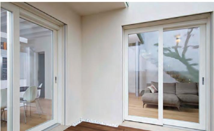
I serramenti costituiscono parte integrante dell'involucro edilizio ed è pertanto fondamentale che le loro caratteristiche siano le più performanti. Al pari delle pareti esterne, infatti, un buon serramento deve essere in grado di evitare le dispersioni di calore, da e verso l'esterno ed isolare acusticamente.
